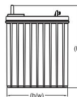
Материал корпуса: полипропилен (PP), согласно UL94-V0 (пожаробезопасное и ударопрочное исполнение)
